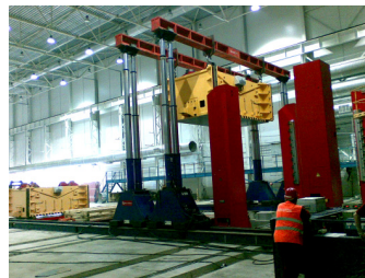
Портальный гидравлический подъемник LS44A, макс. грузоподъемность 800 т
